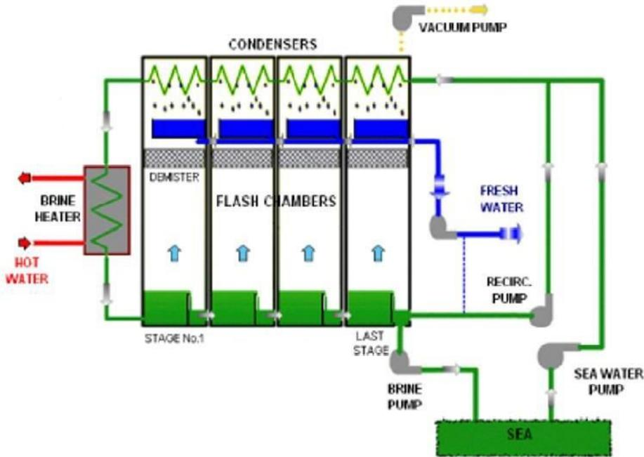
再循環流從 n-2 級流到第一級，在那裡它被冷凝蒸汽逐漸加熱。
